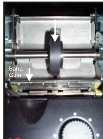
FIGURA 7. Colocando la placa superior metálica
