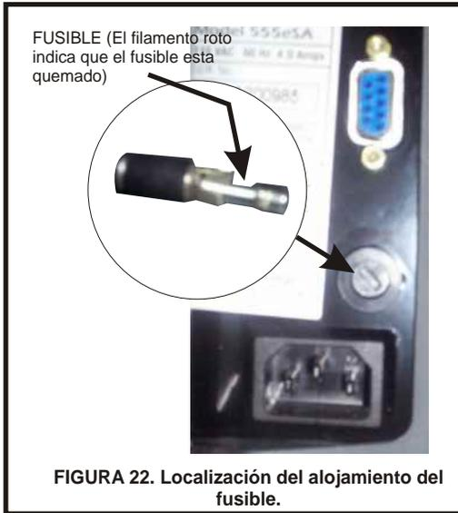
Utilice un probador para comprobar que el fusible esta quemado.
