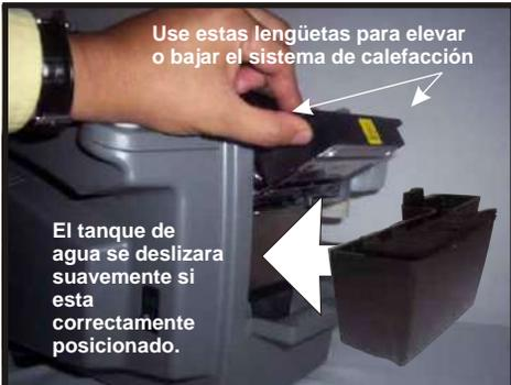
FIGURA 9. Manejo del sistema de calefacción
